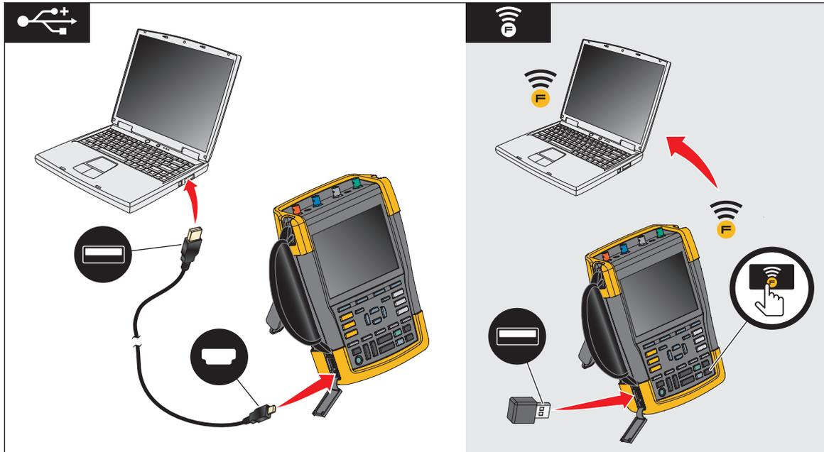
Figure 1. Connexions de l'outil de test au PC
